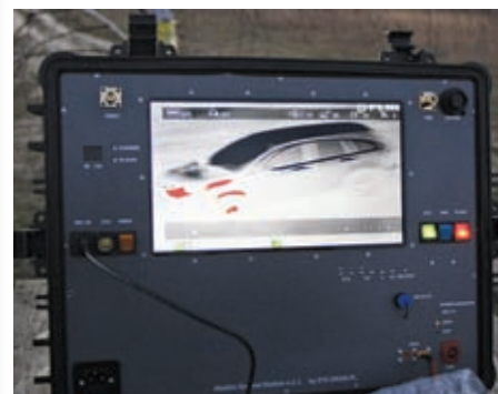
Stacja naziemna, na ekranie obraz z kamery termowizyjnej
