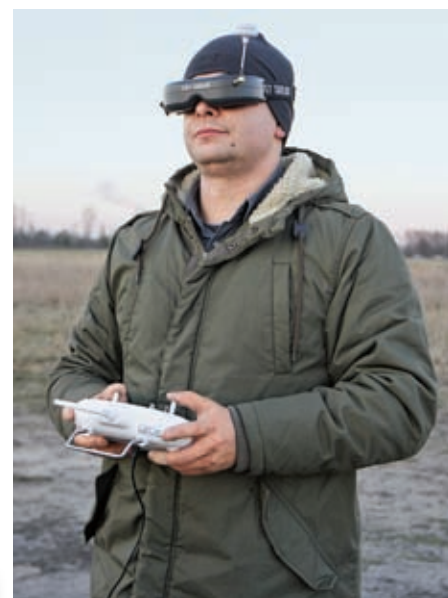
Operator w goglach, przez które widzi obraz z kamery umieszczonej na dronie
